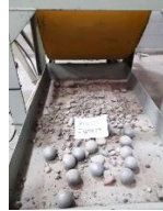
Maquina Los Angeles Ensayo Figura 4. Ensayo de Durabilidad
