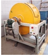
Maquina Los Angeles Ensayo Figura 4. Ensayo de Durabilidad
