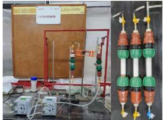
Figura 1. Sistemas continuos utilizados. a) sistema completo con dos reactores de flujo continuo ascendente instalados. b) los tres reactores utilizados para la comparación de las diferentes proporciones de materiales como relleno.
